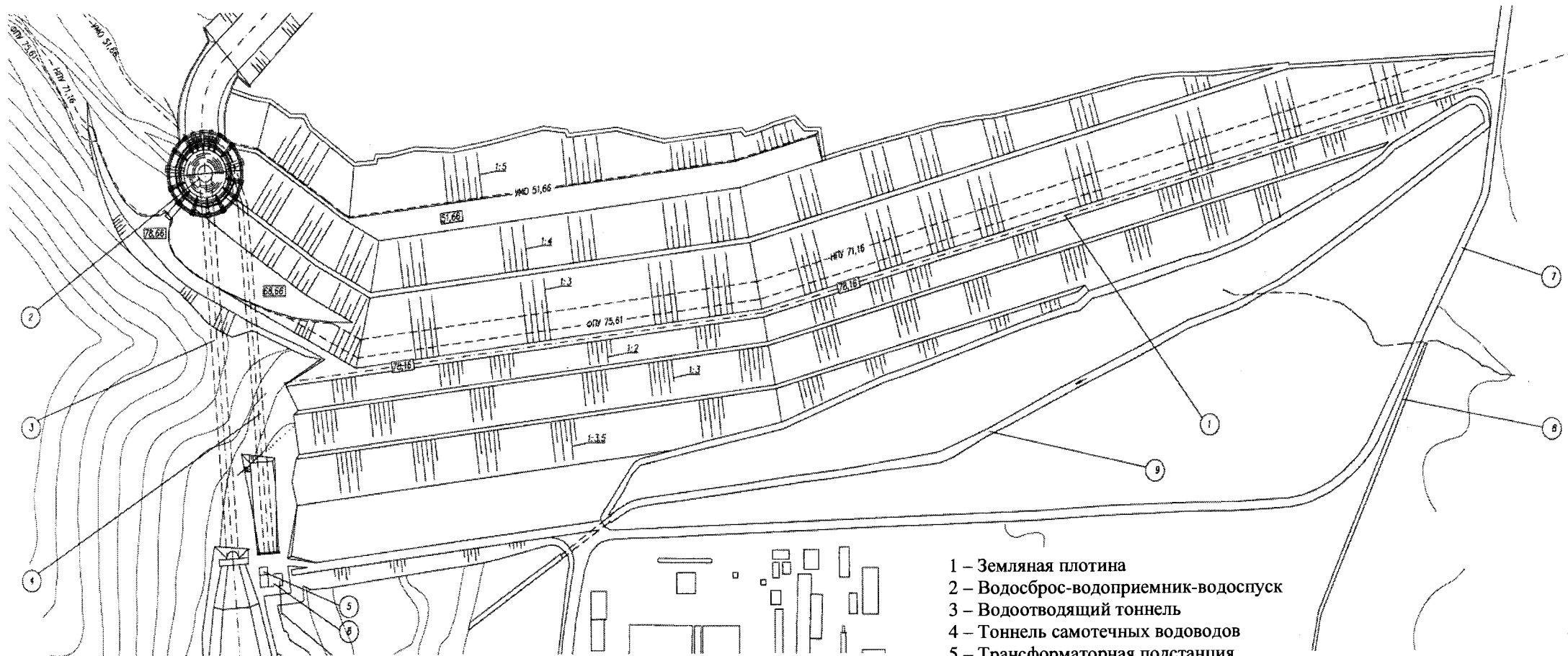
План расположения сооружений Артемовского гидроузла
